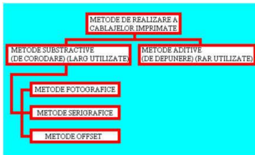
Fig. 3. Metode (tehnologii) de realizare a cablajelor imprimate
