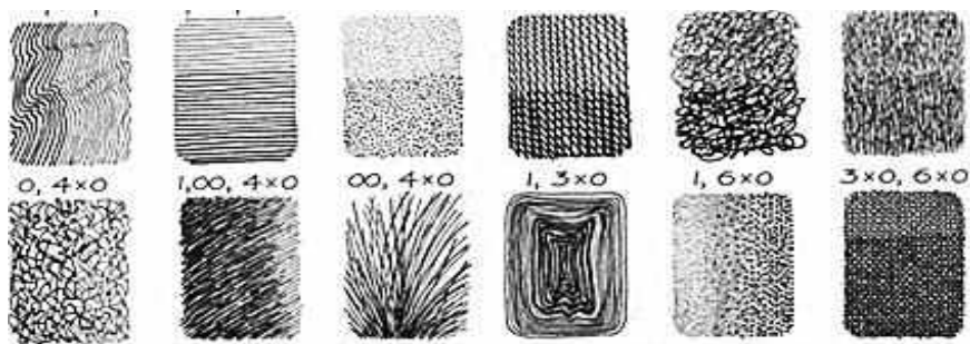
Imag. 15 Tehnici grafice cu diversitatea grosimii liniilor de hașură executate cu rapidograph/isograph
