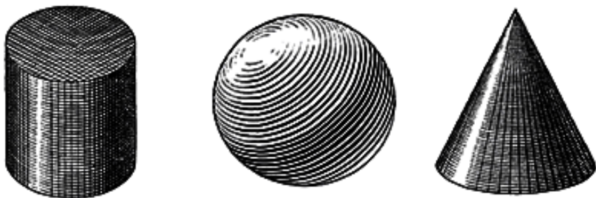
Imag. 10 Tehnici grafice cu linii liniare executate cu rapidograph/isograph
