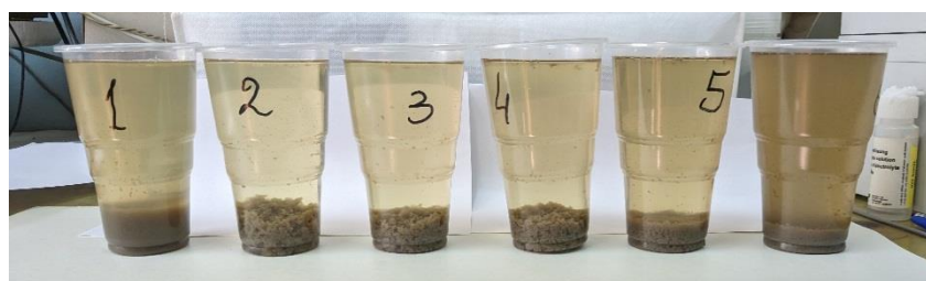
Fig. 2. Teste de floculare și flotare realizate cu apa uzată provenită de la procesarea cărnii de pui la S.R.L. „Floreni”
