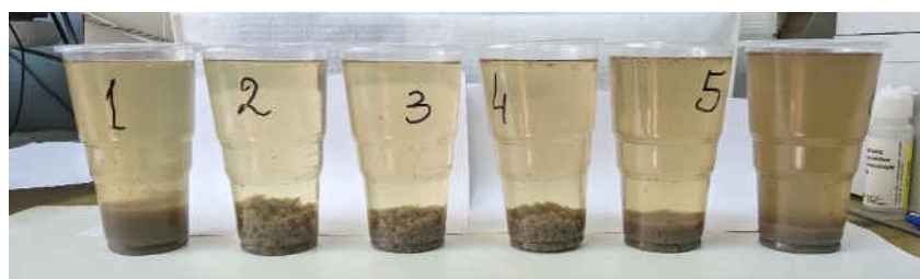
Fig. 2. Teste de floculare și flotare realizate cu apă uzată provenită de la procesarea cărnii de pui la S.R.L. „Floreni”
