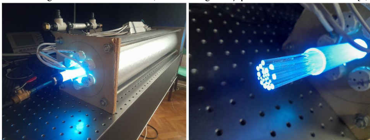
Fig. 2. Tubul de cuarț introdus în echipamentul de decontaminare ce conține 6 lămpi UVC
