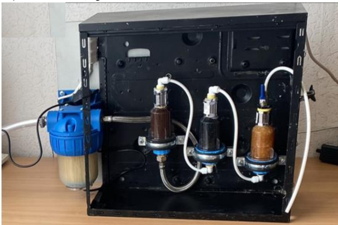
Fig. 1. Instalație pentru demonstrarea tehnologiilor de potabilizare a apelor
