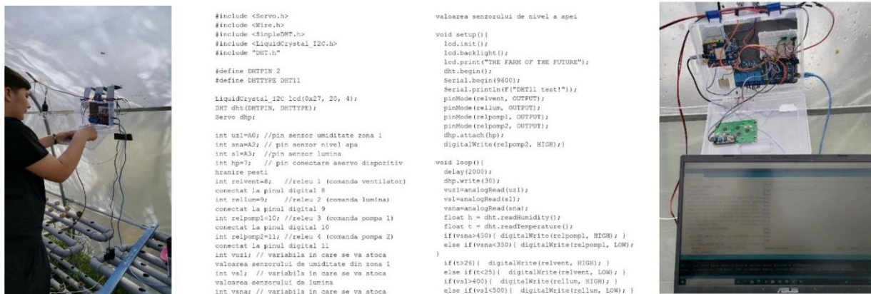
Fig. 2. Construirea, testarea și monitorizarea sistemului IT (pe baza de microcontrolere de tip Arduino)
