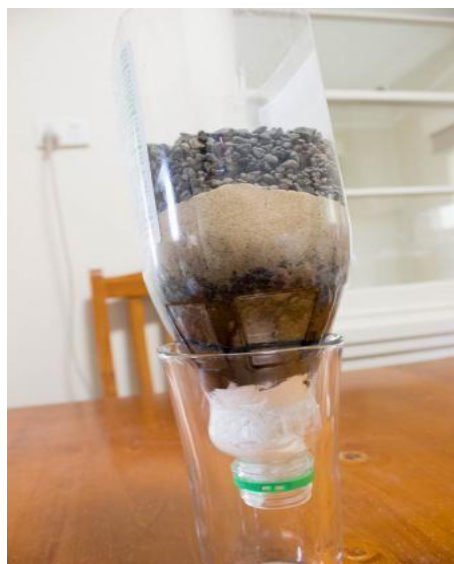
Fig. 5. Sistem de filtrare a apei din materiale uzuale
