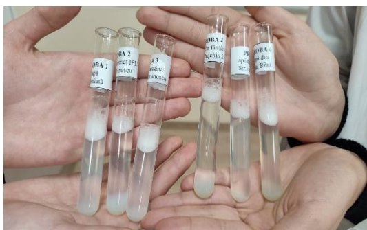
Fig. 2. Determinarea durtății apei cu ajutorul unei soluții de săpun
