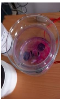
Fig. 9. Electroliza soluției de sare
