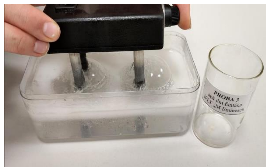
Fig. 3. Determinarea metalelor grele, sărurilor și a impuritatilor din apă cu ajutorul hidrolizatorului
