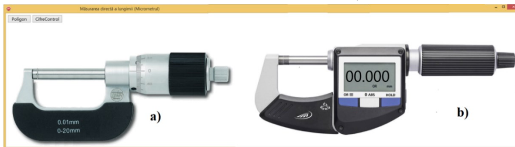
Figura 5. Prezentarea micrometrului (a-(precizie 0.01mm), b-(precizie 0.001mm))
