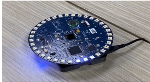
Figura 1. Senzorul MATRIX de detecție a sunetelor, proiectul echipei ASA (IPLT „Gheorghe Asachi” din Chișinău), provocarea Into Orbit , 2019
