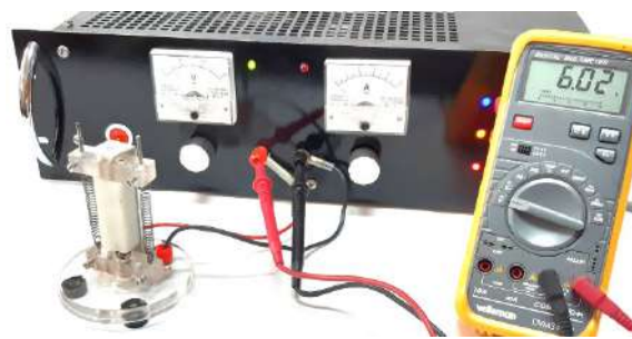
Figura 4. Sistem de zăvorâre cu arcuri de Nitinol
