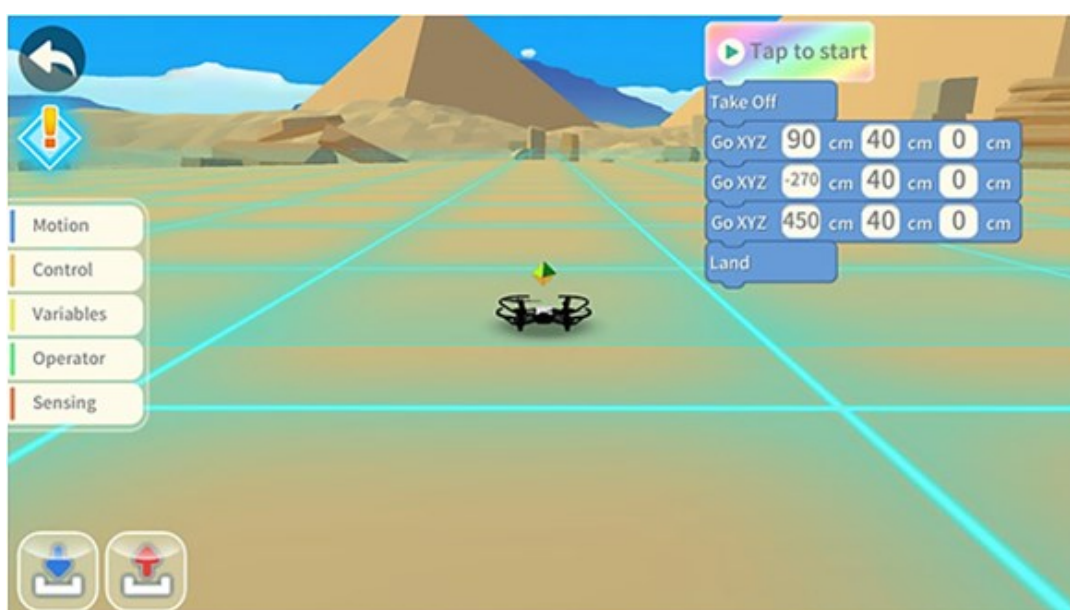
Figura 3.10. Programul pentru realizarea zborului aferent punctului staționar (90; -180; 270)
