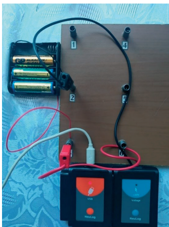
Figura 2. Circuitul pentru măsurarea t.e.m. a sursei de tensiune.
