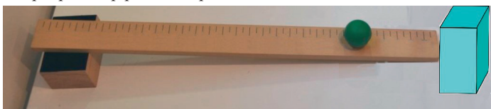
Figura 1. Montajul experimental pentru determinarea vitezei unui mobil
