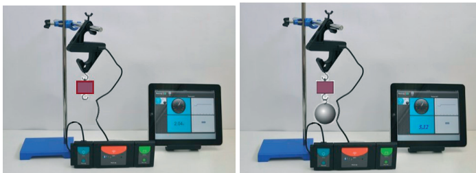
Figura 7. Determinarea ponderii corpurilor cu ajutorul senzorului digital de forță NUL-211
