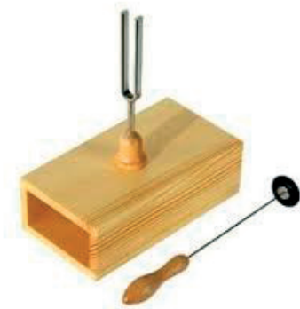
Figura 1. Diapazon și ciocan pentru excitarea diapazonului
