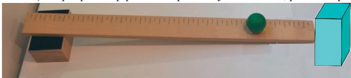
Figură 1. Montajul experimental pentru determinarea vitezei unui mobil
