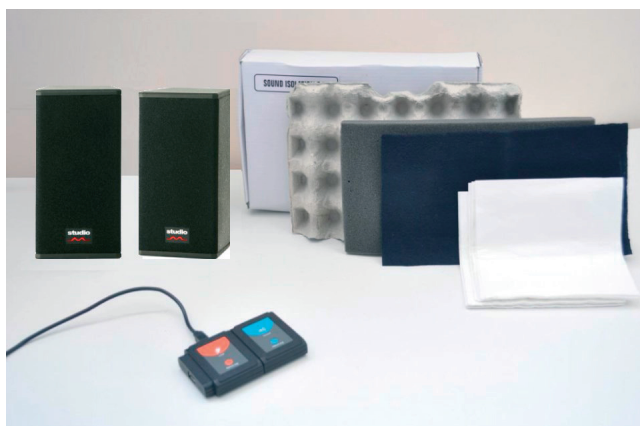
Figura 2. Configurarea experimentului pentru studierea izolației acustice
