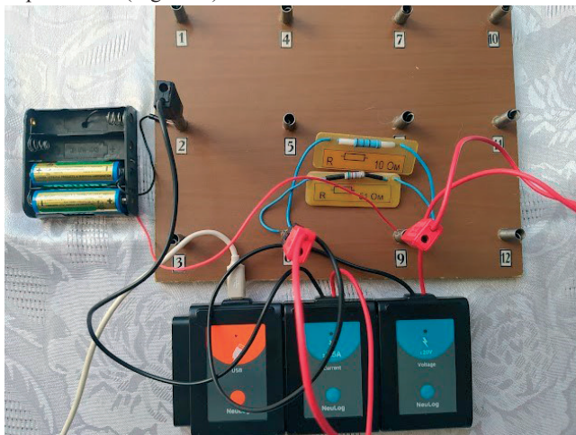
Figura 2. Montajul circuitului pentru măsurarea intensității curentului în circuit și a tensiunii pe ambele rezistoare.
