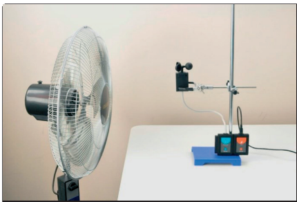
Figura 3. Instalația pentru determinarea vitezei vântului
