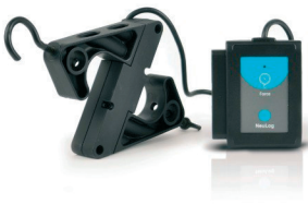
Figura 5. Senzor digital de forță NUL 211
