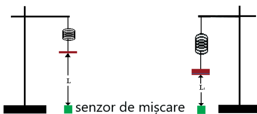
Figura 3. Schema instalației experimentale pentru determinarea alungirii absolute cu senzorul digital de mișcare Nul-213
