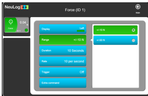
Fig. 3. Selectarea limitei de măsurare a senzorului de forță
