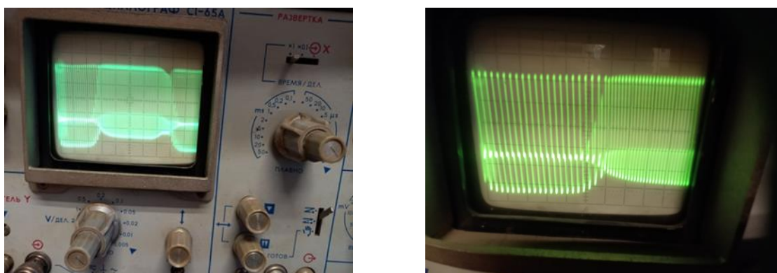
Fig. 3. Oscilogramele unei unde electromagnetice modulate pentru două valori diferite ale timpului de desfășurare a oscilografului
