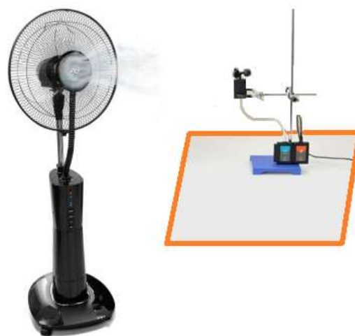
Figura 4. Instalația pentru determinarea vitezei vântului
