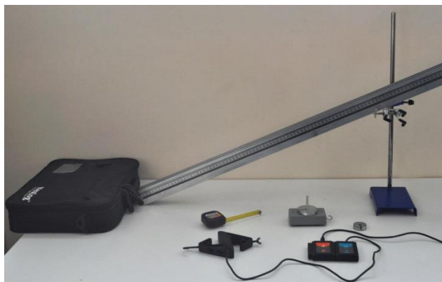
Fig. 5. Configurarea experimentului cu planul înclinat
