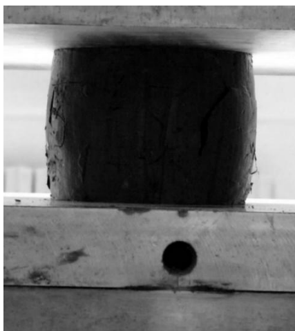
Рис. 2. Испытание образца на одноосное сжатие. Фото О.Чебана
