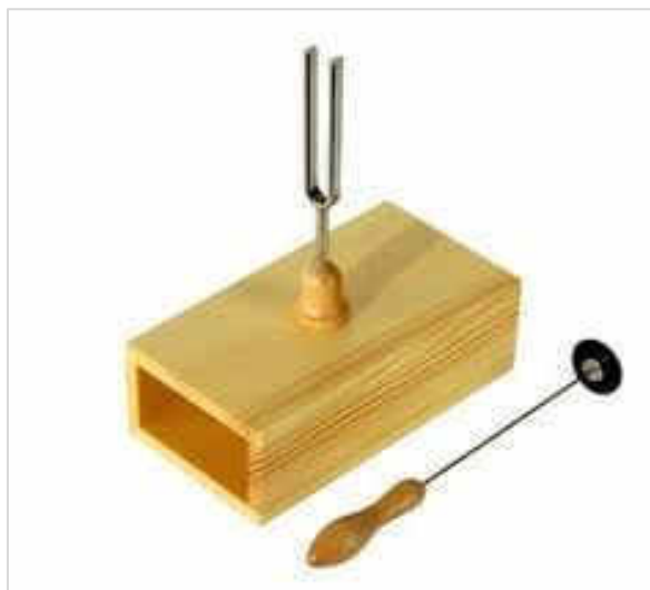
Figura 1. Diapazon și ciocan pentru excitarea diapazonului
