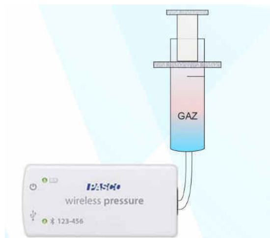
Figura 1. Montajul experimental pentru studiul P(V) la t=\text{const}
