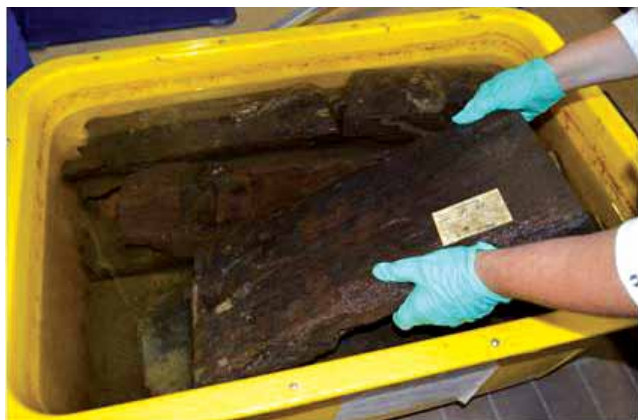
Fig. 4. Depozitarea grinzilor de lemn într-un mediu similar celui arheologic 21
